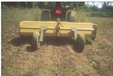
Lámina 54 Trituradora usada para cortar residuos de algodón. (T. Friedrich)
