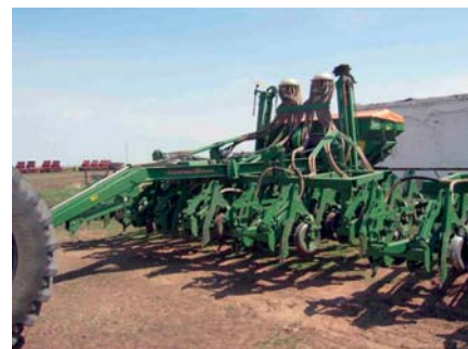
Lámina 97 Sembradora a chorrillo neumática de no labranza, con dos unidades centrales de medición y distribución (T. Friedrich)
