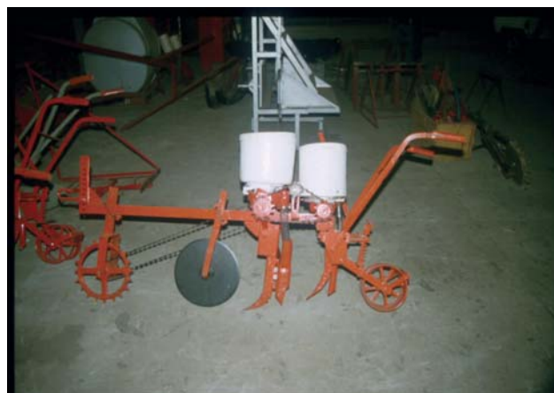
Lámina 74 Plantadora con abridor de azada para fertilizar y sembrar después del corte del disco. (T. Friedrich)
