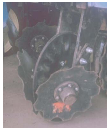
Lámina 83 Limpiador de hileras combinado con disco de corte. (T. Friedrich)
