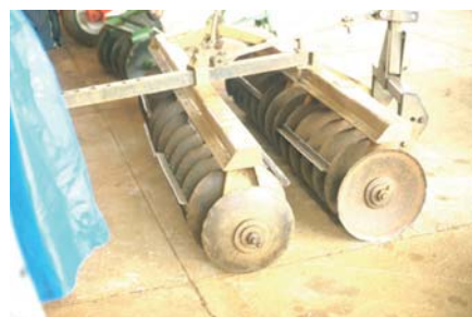
Lámina 50 Grada de discos modificada para ser usada como rodillo de cuchillas (T. Friedrich)
