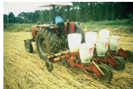
Lámina 98 Pequeña sembradora de precisión de cultivos de hileras (T. Friedrich)
