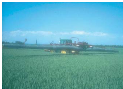
Lámina 64 Pulverizador de barra montado en tractor con funda de aire para reducir la deriva de herbicidas (T. Friedrich)
