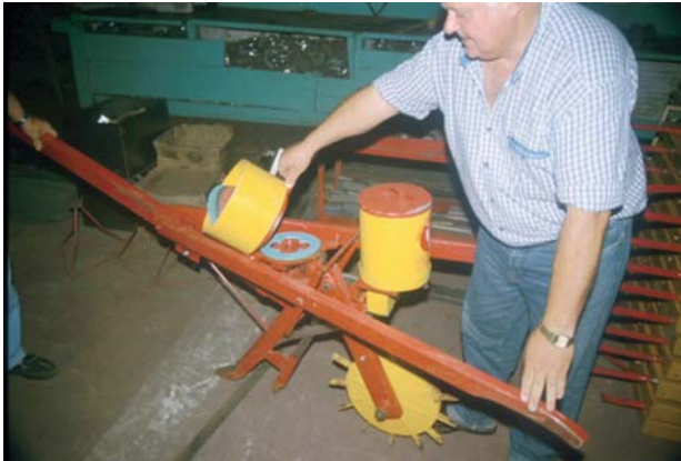
Lámina 79 El plato de semilla de plantadora estándar de tractor en una plantadora simple de tracción animal (T. Friedrich)
